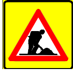
(T-15) YOLDA ÇALIŞMA
